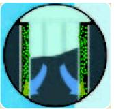
При обратной промывке (запускается по таймеру или по разнице давления) клапан переключает поток жидкости с впуска на коллектор дренажа. Жидкость меняет свое направление и изнутри элемента смывает загрязнения с внешней стороны в дренаж, находящийся в основании корпуса.
